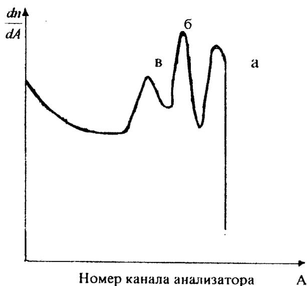
Рис. 9. Спектр импульсов  $\gamma$ -квантов  $^{12}\text{C}$  ( $E_{\gamma}=4,43$  МэВ), измеренный спектрометром с кристаллом NaI(Tl) размерами 2,6·7,6 см: а - пик полного поглощения (4,43 МэВ); б- пик одиночного вылета (3,92 МэВ); в - пик двойного вылета (3,41 МэВ)
