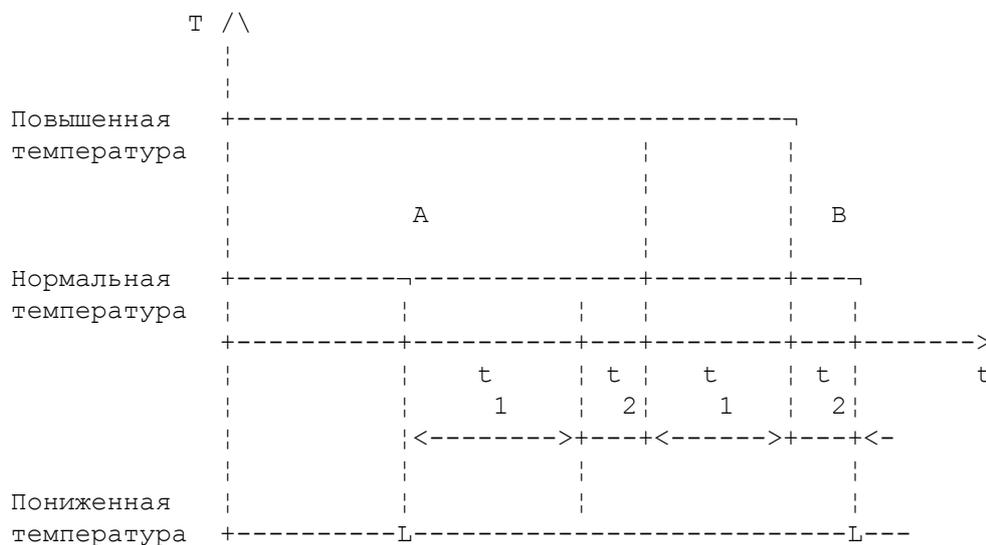
Т - температура в камере; t - текущее время; А - начало цикла;
